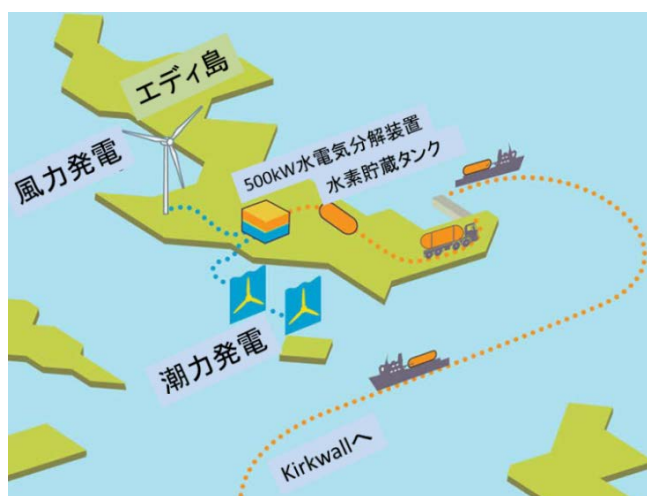
【図 1】「Surf 'n' Turf」プロジェクトの概要。エディ島に建設された再エネで発電した電力を水素に変えてタンカーで Kirkwall に運び、燃料電池で発電(出所: Community Energy Scotland)
